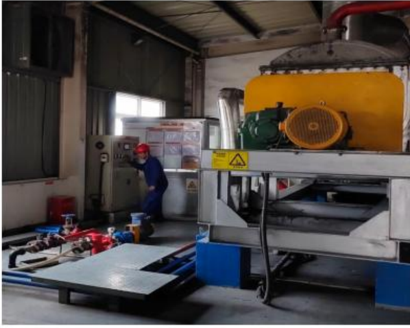
炼油房操作人员陈一夫立即跑到开关柜按下设备急停按钮，炼油设备停止运行
